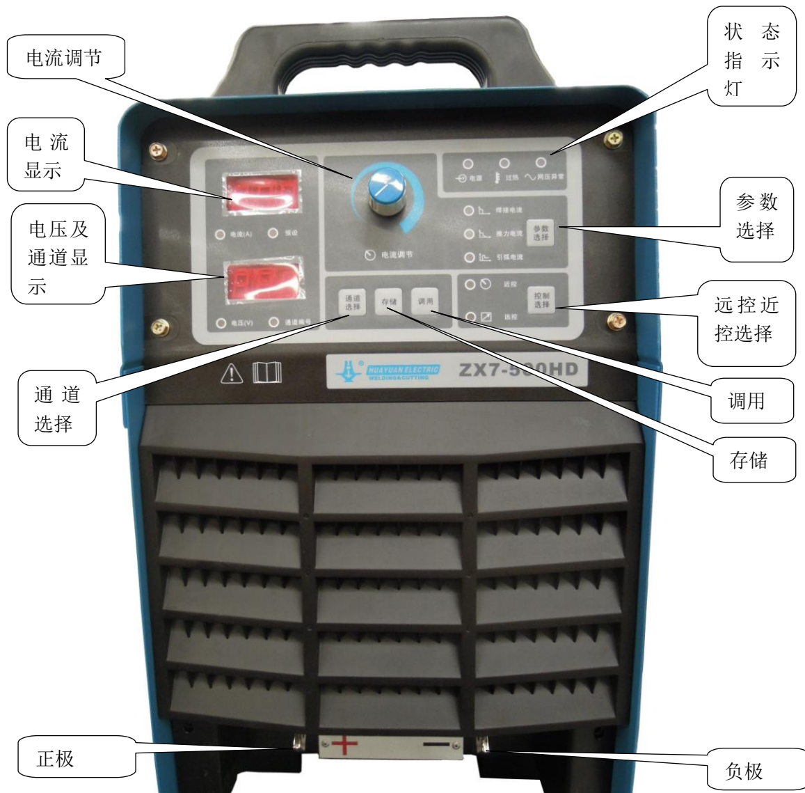
图3 ZX7-HD 系列逆变式直流弧焊机前视图
